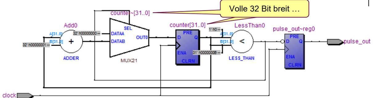
Im „RTL netlist viewer“ von Quartus erkennt man jedoch, dass „counter“ mit vollen 32 Bits implementiert wurde, obwohl der Zähler nie über 11 (= 4 Bits) hinauskommt. Ausserdem sieht man auch, dass für das Inkrementieren des Zählers entsprechend ein 32-Bit Addierer verwendet wird. Dazu kommt noch, dass die „Less Than“ Funktion auch aus einem 32-Bit Subtrahierer besteht.
