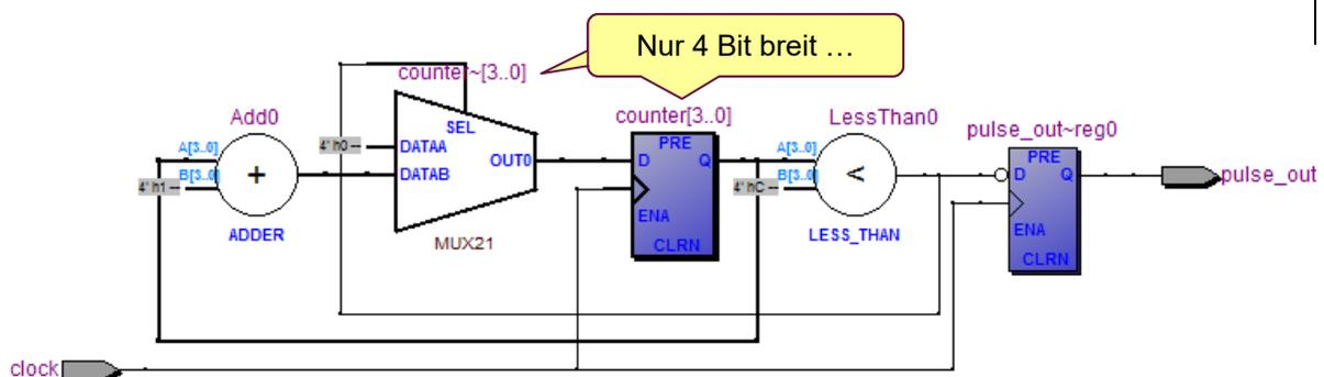
Durch die einfache Umstellung von INTEGER auf UNSIGNED (3 DOWNT0 0) kann man hingegen den Aufwand von 43 auf nur 5 Logik-Elemente reduzieren(!!!).
