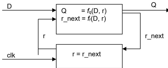
Die Figur zeigt die schematische Darstellung eines Moduls mit 2 Prozessen. Alle Eingänge sind mit „D“ markiert und mit dem kombinatorischen Prozess verbunden. Registrierte Signale kommen als „r“ in den kombinatorischen Prozess, und verlassen diesen als „r\_next“.
